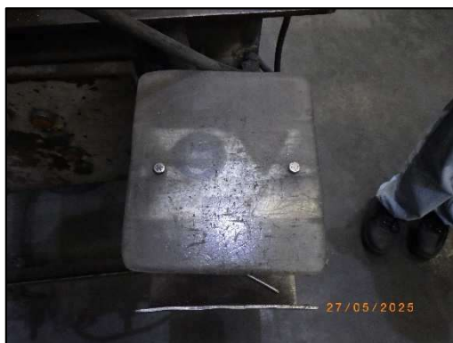
รูปที่ 3-37 การติดตั้งวัสดุกระเด็นเข้าตาที่เครื่องจักร
